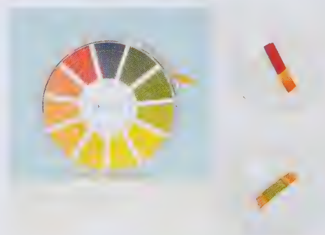
Le papier pH permet de mesurer le caractère acide, basique ou neutre d'une solution.
