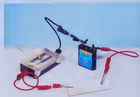
Les métaux (ici le cuivre) conduisent le courant électrique.
