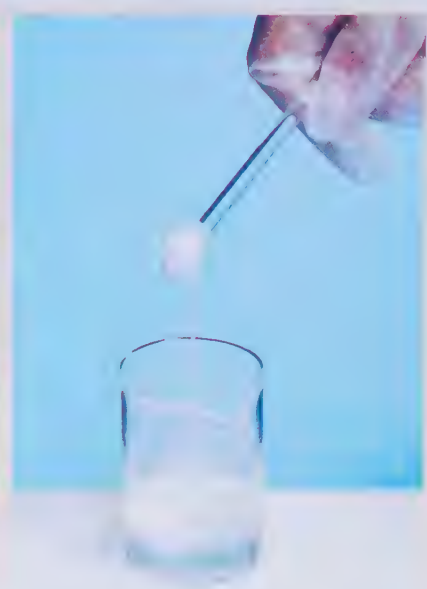
③ Étirer doucement le fil avec une baguette de verre.
