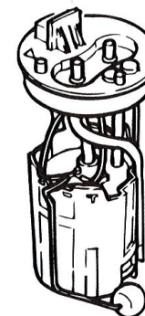
Figure 29.11. Pompe d'alimentation intégrée dans le réservoir
