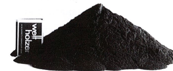
Figure 23.1. Quantité de poussière obtenue au bout de 10 000 km : 500 g (moteur diesel routier de 180 kW) (Doc. Mann)
