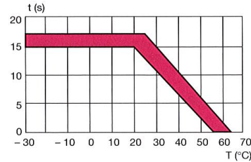
Figure 96.9. Postchauffage temporisé (Doc. Mercedes-Benz)
