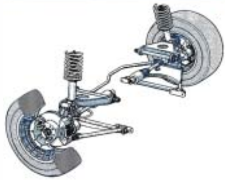
Figure 14.16 • Train roulant d'un véhicule à tendance sportive : - roues en alliage léger ; - triangles de suspension allégés, etc. (document Renault).
