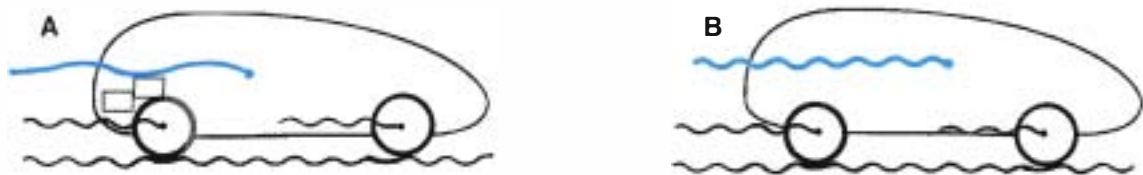
A. En charge : suspension correcte. B. À vide : suspension dure et inconfortable.
