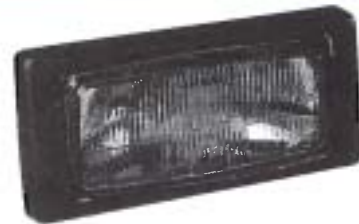
Figure 19.7 • Projecteur complémentaire antibrouillard.
