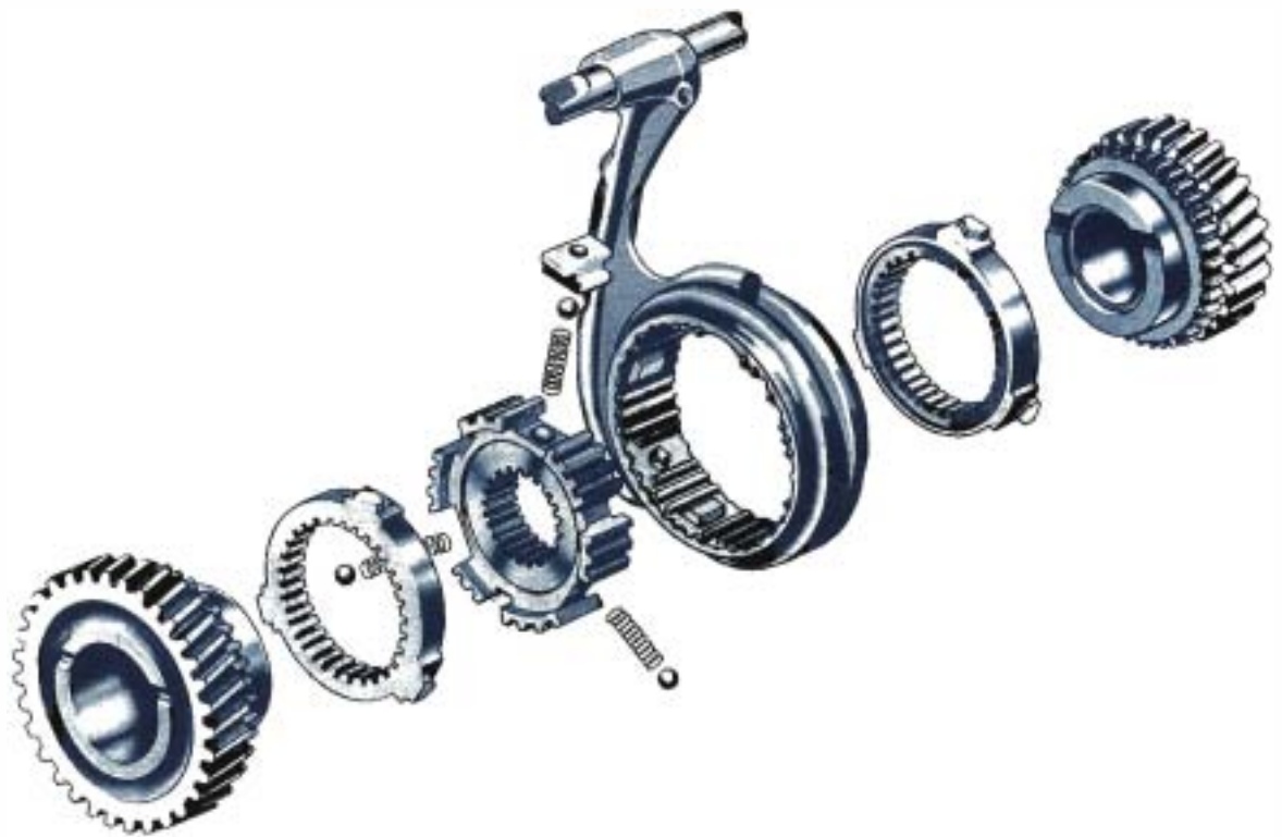
Figure 3.15 • Éléments d'un synchroniseur (document Citroën). De gauche à droite : pignon fou, bague de synchro, moyeu de synchro, couronne.
