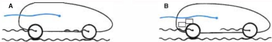
A. À vide : suspension souple. B. En charge : abaissement exagéré de la hauteur de coque.
