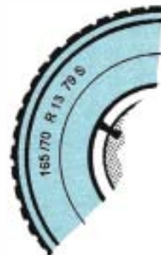
Figure 18.10 • Exemple de marquage.
