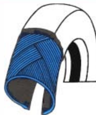
Figure 18.5A • Carcasse diagonale à plis croisés. (document Michelin).
