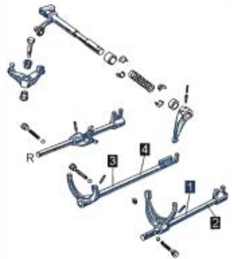
Figure 3.18 • Commande des vitesses (document Citroën).
