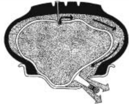
Figure 18.8 • Enveloppe avec chambre à air. Mise à plat instantanée (document Michelin).
