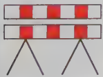
Barrages. Signalisation de position de travaux ou de tout autre obstacle de caractère temporaire
