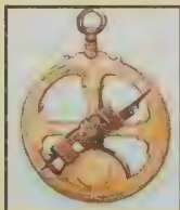
Astrolabe : cet instrument permet de trouver la position géographique grâce aux étoiles.
