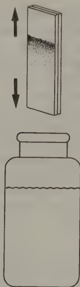
Figure 18.2 Méthode rudimentaire de préparation des plaques chromatographiques de dimension réduite ( 2 \times 10 cm)
