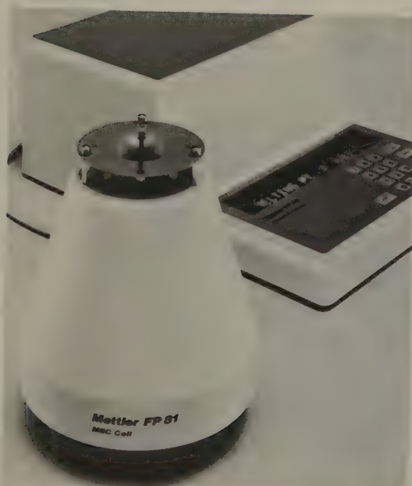
Figure 19.3 Appareils électriques à bloc métallique a) appareil Mettler b) appareil Gallenkamp
