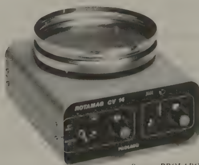
Figure 8.5 Plaque chauffante avec agitation magnétique
