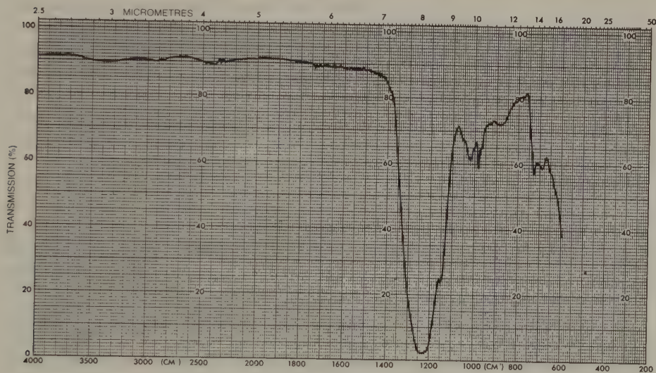
Spectre 22.7 Spectre IR d'un perfluorokérosène (liquide pur en film)
