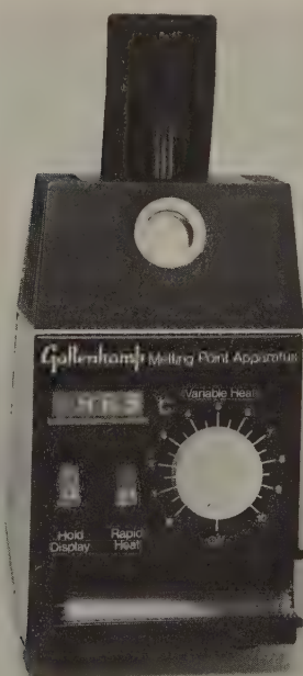
Figure 19.3 Appareils électriques à bloc métallique a) appareil Mettler b) appareil Gallenkamp
