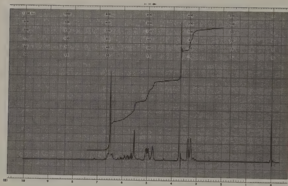
Spectre 42.4 Spectre de RMN de l'ortho eugénol (solution dans \text{CCl}_4 )
