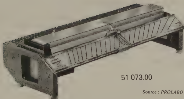
Figure 19.5 Banc Kofler (à gradient de température)
