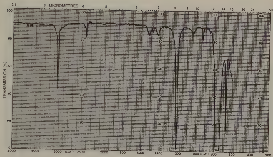
Spectre 22.3 Spectre IR du trichlorométhane (chloroforme, liquide pur en film)
