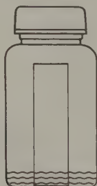
Figure 18.7 Modèle de cuve chromatographique pour plaque de petite dimension
