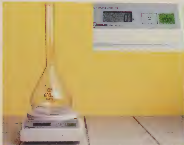
1 Avant d'introduire le liquide, on place le récipient sur la balance et on fait la tare.
