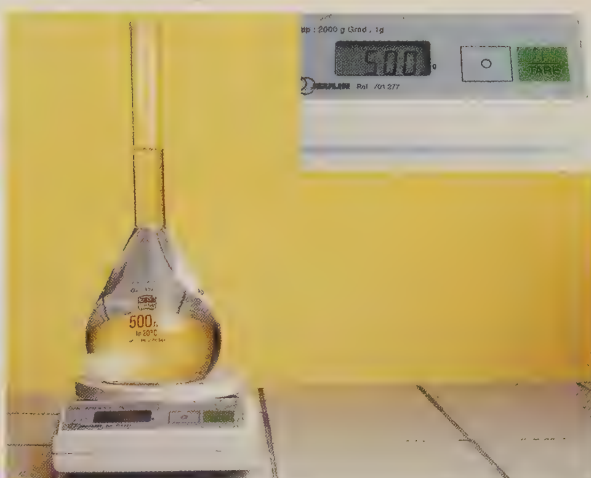
2 Mesure de la masse m_1 de 500 mL d'eau.
