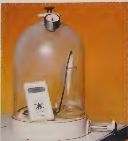
Ébullition de l'eau pure sous pression réduite.
