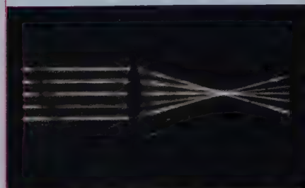
FIG. 8 Faisceau de rayons parallèles qui convergent. La lumière traversant une lentille subit une ou deux réfractions.
