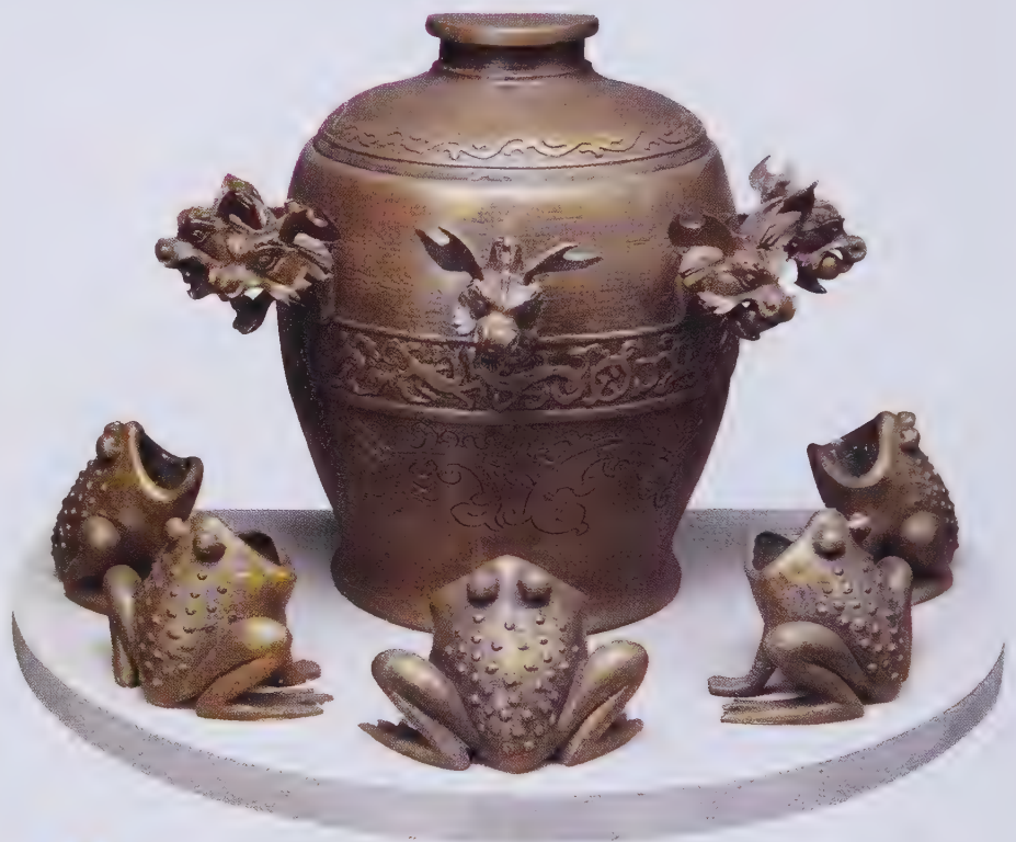
2 Réplique du sismographe de Zhang Heng (78-139 ap. J.-C.) sous la dynastie Han.
