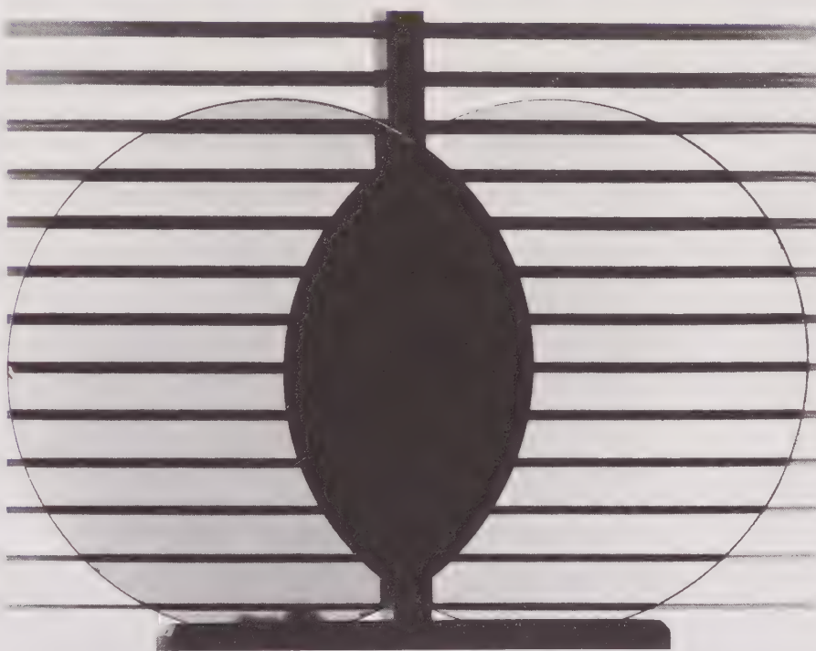
Figure 5.4 Deux disques de matière polarisante, dont les axes sont perpendiculaires l'un à l'autre, sont transparents, sauf dans la région où ils se recouvrent, qui est alors opaque. Il est facile de vérifier cela avec deux paires de lunettes de soleil Polaroid.
