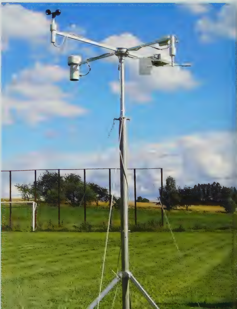
2. Les éléments d'une station météorologique : l'anémomètre, le thermomètre et le pluviomètre.
