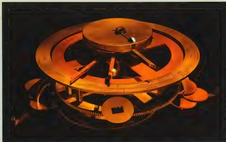
1. Le mécanisme d'Anticythère (I er siècle av J.-C.), une machine à calculer la date des éclipses.
