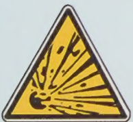
Matières explosives Risque d'explosion
