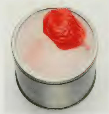
▲ FIGURE 8.9 Influence de la température sur le volume Si on place un ballon dans l'azote liquide (77 K), il se contracte à mesure que l'air qu'il contient refroidit et occupe un volume moindre à la même pression externe.
