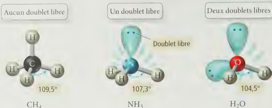
▲ FIGURE 6.6 Influence des doublets libres sur la géométrie moléculaire Les angles de liaison diminuent progressivement à mesure que le nombre de doublets libres sur l'atome central augmente de zéro dans CH 4 à deux dans H 2 O en passant par un dans NH 3 .
