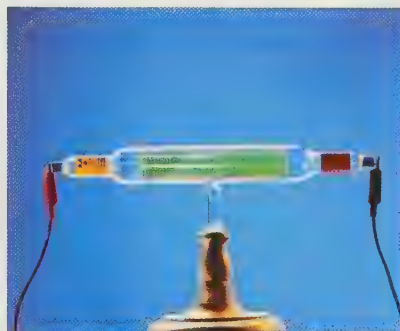
▲ FIGURE 3.2 Tube à rayons cathodiques Les rayons cathodiques sont émis par l'électrode chargée négativement, la cathode, et se déplacent vers l'électrode chargée positivement, l'anode. Les rayons deviennent « visibles » lorsque leur collision avec l'extrémité du tube recouvert d'un matériau fluorescent produit une émission de lumière.
