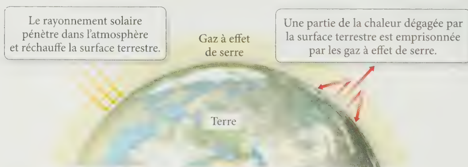
▲ FIGURE 9.1 Effet de serre Les gaz à effet de serre (dont les principaux sont le méthane, le dioxyde de carbone et la vapeur d'eau) agissent dans l'atmosphère comme un filtre à sens unique. Ils laissent passer l'énergie solaire qui réchauffe la surface terrestre, mais ils empêchent la chaleur de retourner dans l'espace.
