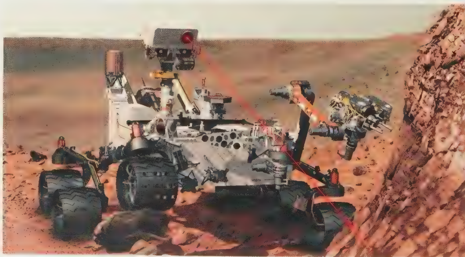
► FIGURE 8.1 Le rover Curiosity Les minilaboratoires du rover font notamment appel à une caméra couplée à un laser (le système ChemCam) qui leur permet de déterminer à distance la composition chimique des roches. Le laser vaporise l'échantillon et excite les atomes qui réémettent de la lumière UV ou visible (voir la section 3.2). Celle-ci est alors captée par la caméra et analysée.
