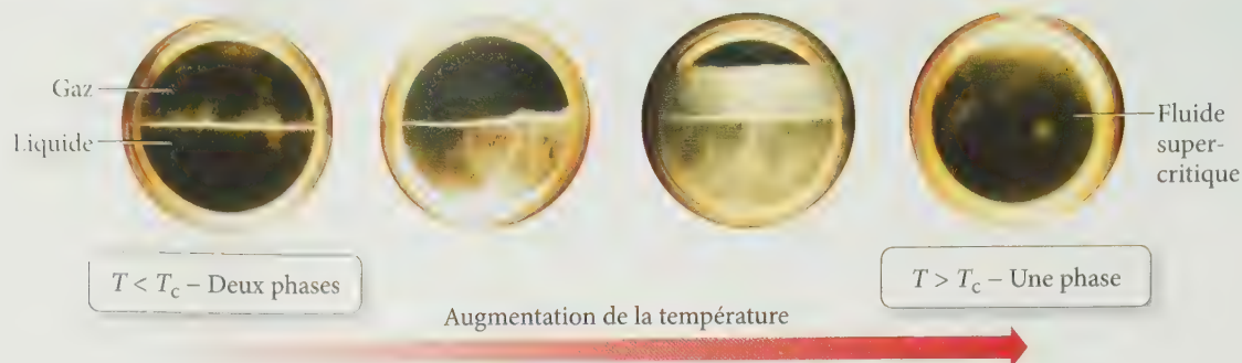
▲ FIGURE 7.31 Transition des points critiques Quand on chauffe du n -pentane dans un contenant scellé, il se transforme en fluide supercritique. Au point critique, le ménisque qui sépare le liquide et le gaz disparaît, et le liquide devient supercritique, c'est-à-dire ni liquide, ni gaz.
