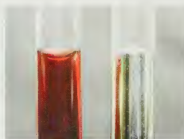
▲ FIGURE 7.12 Ménisques de l'eau et du mercure Le ménisque de l'eau (colorée en rouge pour une meilleure visibilité, à gauche) est concave parce que les molécules d'eau sont plus fortement attirées par les parois de verre qu'elles ne le sont entre elles. Celui du mercure est convexe parce que les atomes de mercure sont plus fortement attirés l'un à l'autre que par les parois de verre.
