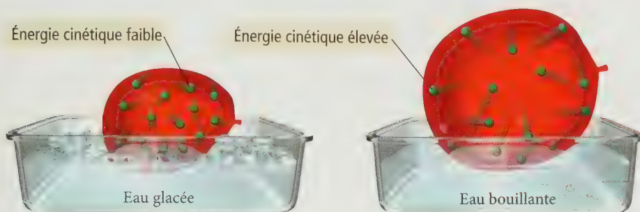
▲ FIGURE 8.8 Interprétation moléculaire de la loi de Charles Si on déplace un ballon gonflable d'un bain d'eau glacée à un bain d'eau bouillante, son volume prend de l'expansion lorsque les particules de gaz dans le ballon se déplacent plus rapidement (en raison de la température plus élevée) et occupent collectivement plus d'espace.
