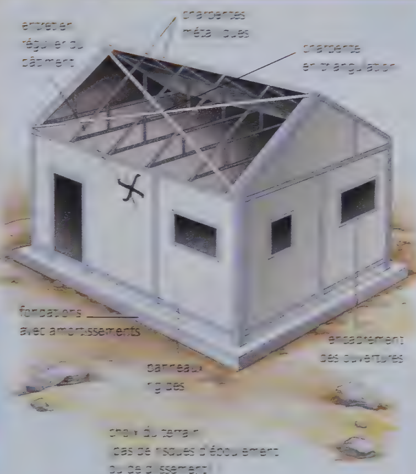
5 Une maison parasismique. Les règles de construction imposées par le PPR doivent permettre aux bâtiments de résister le mieux possible à un séisme.
