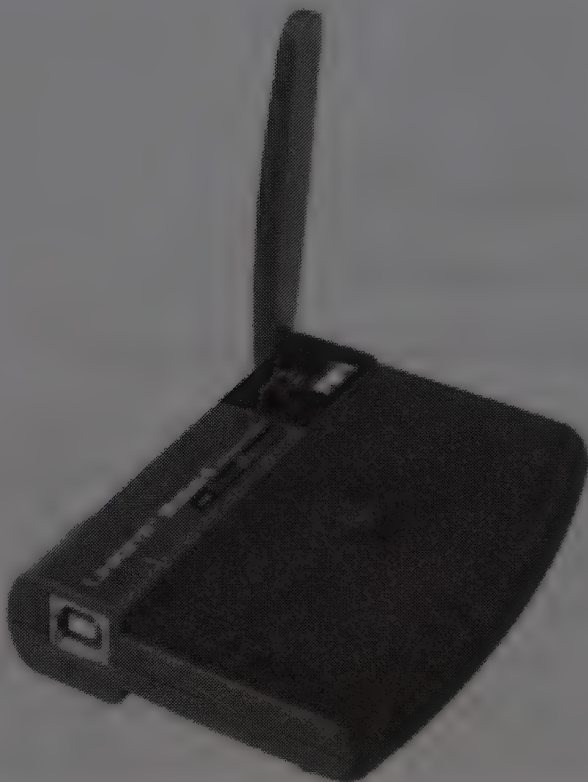
Figure 2.9 : Un adaptateur Wi-Fi USB permet à un ordinateur de bureau de se connecter à votre réseau local sans fil.
