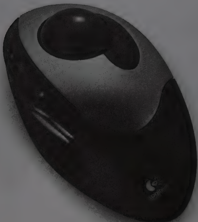
Figure 10.7 : Un trackball avec sa boule caractéris- tique.
