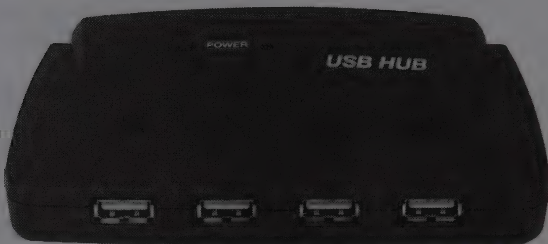
Figure 7.2 : Démultipliez un port USB grâce à un réplicateur.
