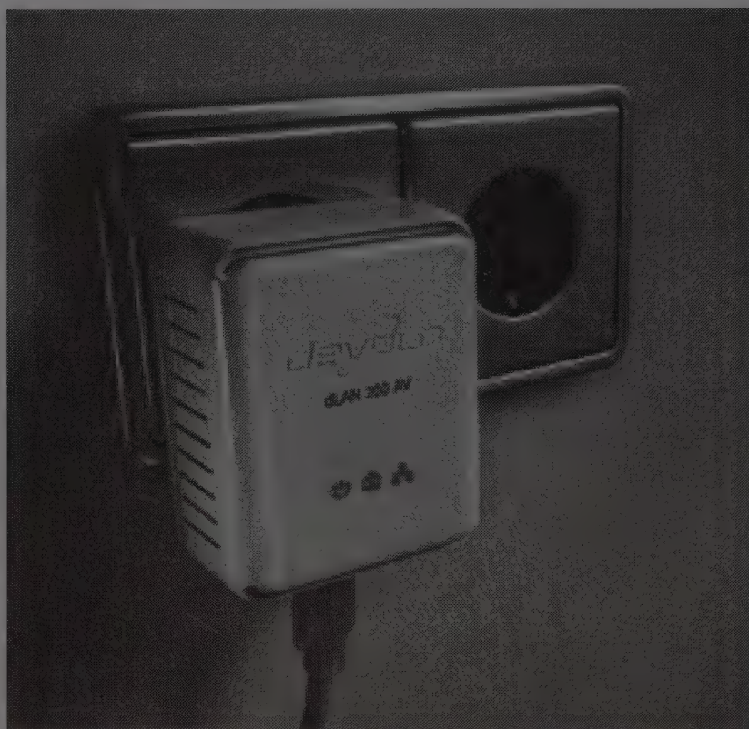
Figure 1.2 : Une prise CPL se branche directement sur une prise de courant sans installa- tion spéciale.
