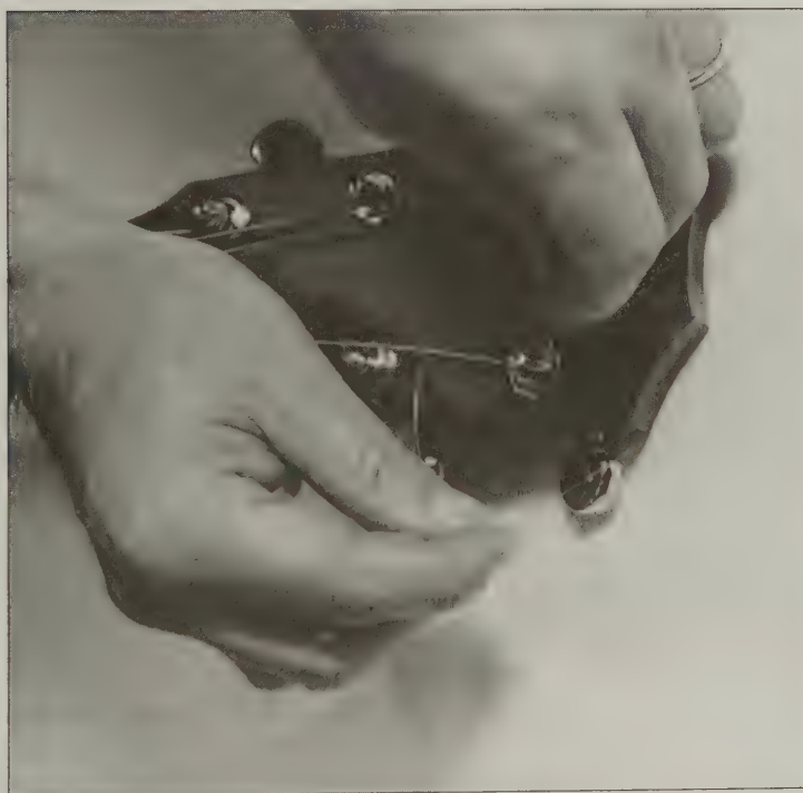
Figure 17-2 : une corde entortillée vers l'inté- rieur de la tête, avec du jeu pour pouvoir l'enrouler.
