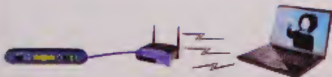
Figure 13.4 : Un point d'accès sans fil connecté au routeur.
