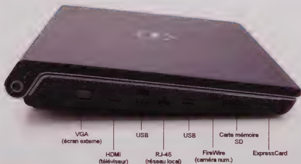
Figure 1.1 : Les connecteurs d'un ordinateurs portable haut de gamme (Dell Studio 17).
