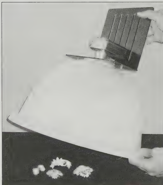
Figure 5.15 : Dispositif pour photogra- phier des objets réfléchissant la lumière et leur environne- ment.
