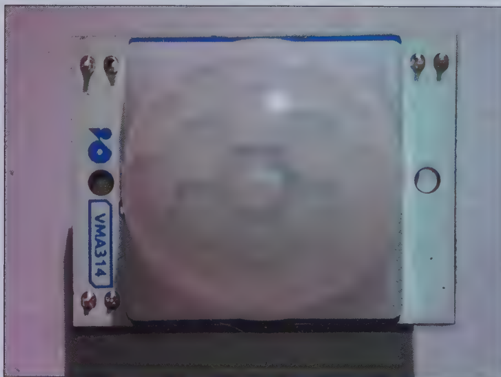
Figure 16.4 : Le détecteur de mouvement PIR.
