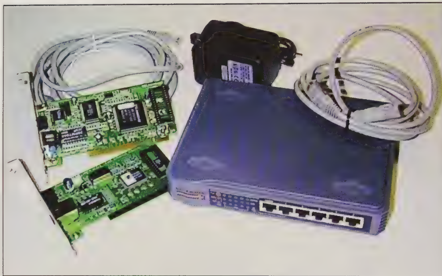
Figure 4.2 : Un concentrateur et ses cartes réseau.
