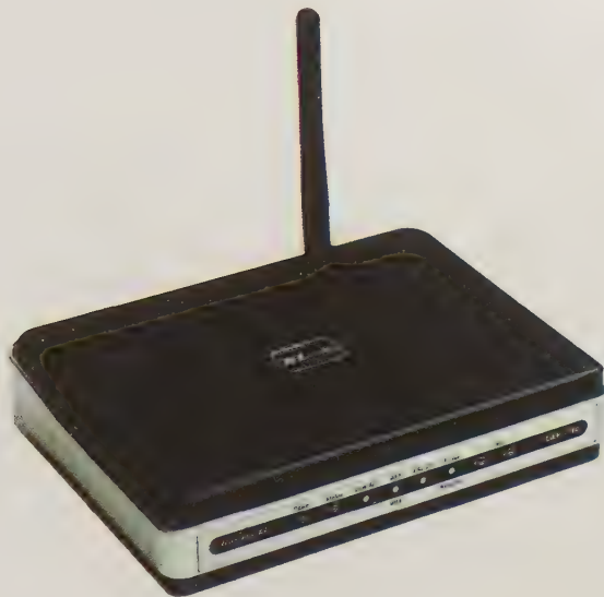
Figure 4.4 : Un point d'accès.
