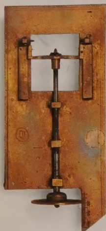
Micromètre utilisé avec un télescope
