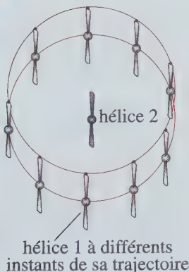
Figure 5.6 – Le cercle d'en bas est la trajectoire du centre de l'hélice, et celui d'en haut la trajectoire de l'extrémité de la pale de l'hélice.
