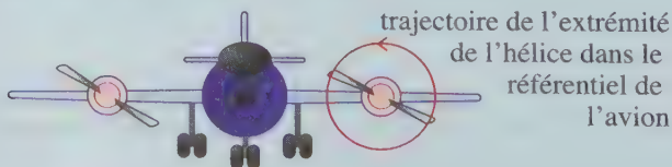
Figure 5.3 – Trajectoire de l'extrémité de la pale dans le référentiel lié à l'avion.
