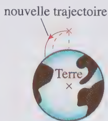
Figure 7.6 – Chute libre avec une vitesse initiale horizontale importante.
