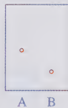
Figure 9.10 – A et B sont élués par différents solvants.
