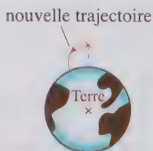
Figure 7.5 – Chute libre avec une vitesse horizontale initiale petite.
