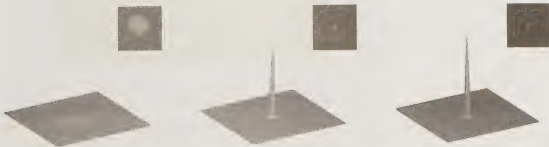
Figure 19. Image et fonction d'étalement de point d'un objet ponctuel dans le cas d'observations limitées par le seeing (à gauche), en optique adaptative (au milieu), et dans le cas d'un télescope parfait hors atmosphère (à droite).
