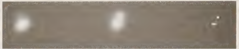
Figure 20. Déconvolution d'un système d'étoiles doubles séparées seulement de 35 millièmes de seconde d'angle. À gauche, l'image d'une source ponctuelle (fonction d'étalement de point), au milieu le système binaire tel qu'observé, et à droite, le système nettement résolu après déconvolution, en utilisant la fonction d'étalement de point de gauche. Images VLT/NACO.
