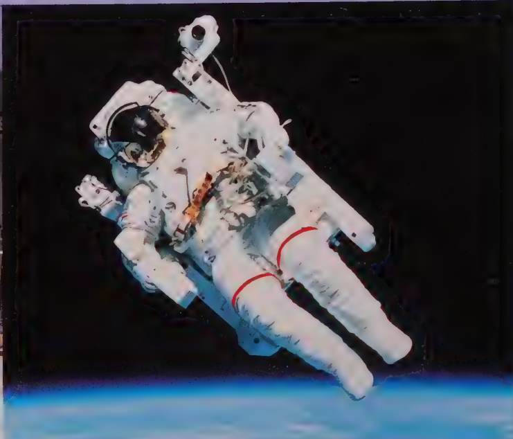
Sur un siège. Cet astronaute (photo ci-dessus) se déplace dans l'espace sur un siège muni de minifusées.
