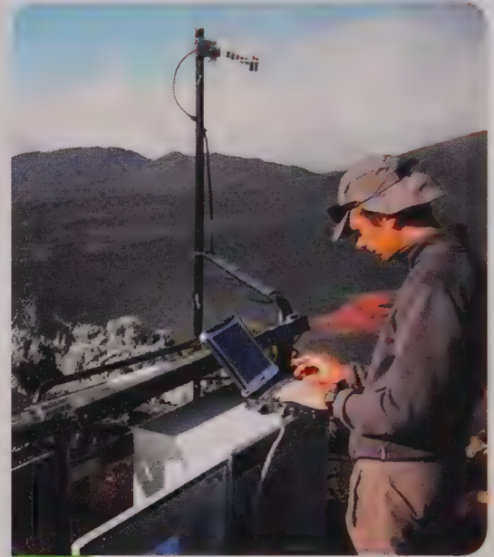
Doc. 2 Installation d'une station sismique GPS sur le Piton de la Fournaise (île de la Réunion)
