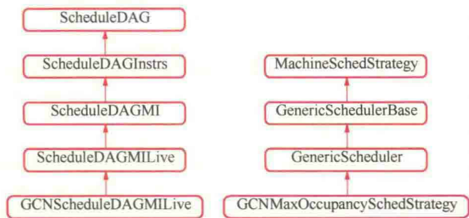
图 6-6 GCN 最大占用率调度器和调度策略实现类的继承关系
