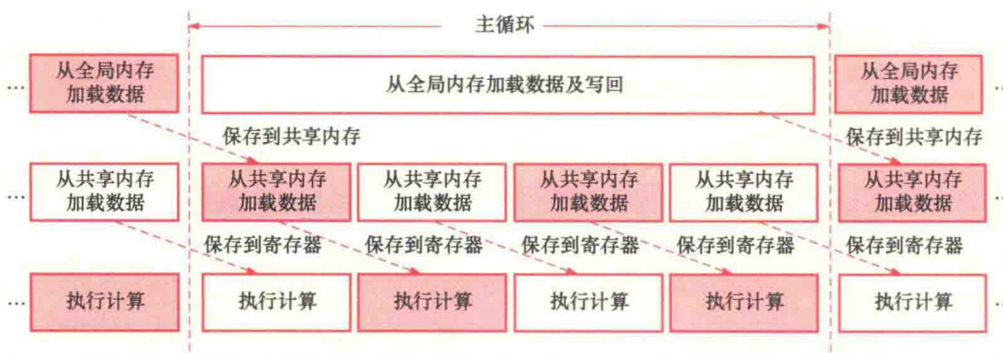
图 5-13 GEMM 实现中的流水线结构
