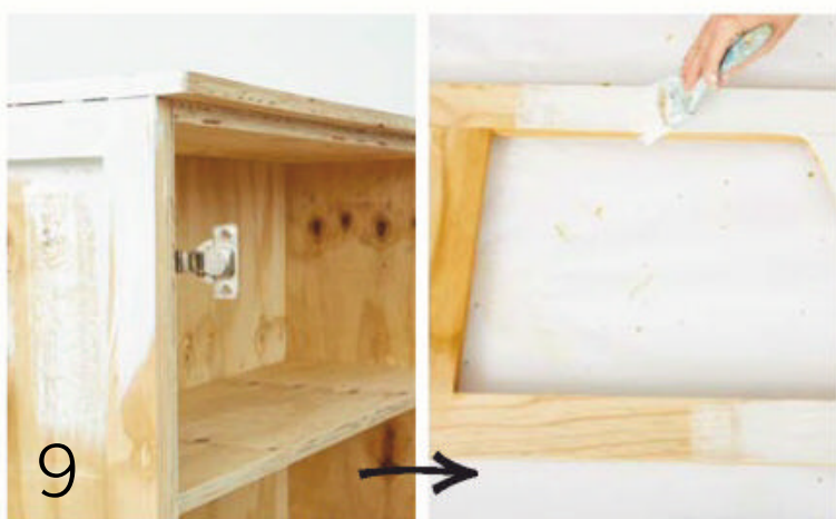
9 Verf die kas en deure aan die buitekant met onderlaag en laat dit droog word.
