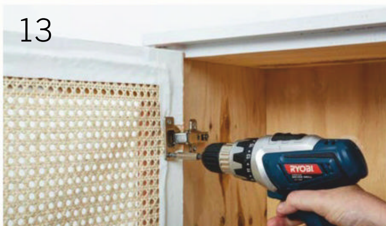
13 Sit weer die handvatsels aan die deure en skroef die deure weer aan die kas vas. 🏠
