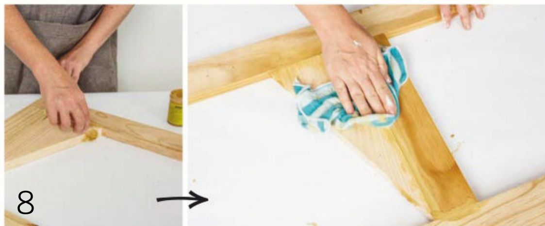
8 Vul alle skroefgate en gleuwe met houtvuller. Wag tot die houtvuller droog is en vee dan enige oortollige vuller af met 'n klam lap.
