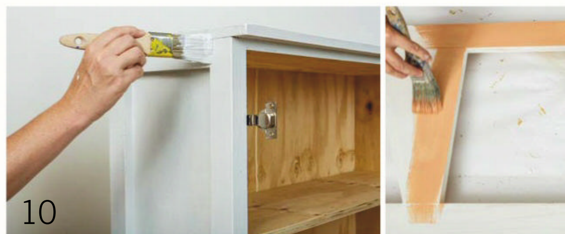
10 Sodra die onderlaag droog is, kan jy die kas verf met twee lae Darling White en die deure met twee lae Orange Kloof; laat die verf droog word tussen lae.
