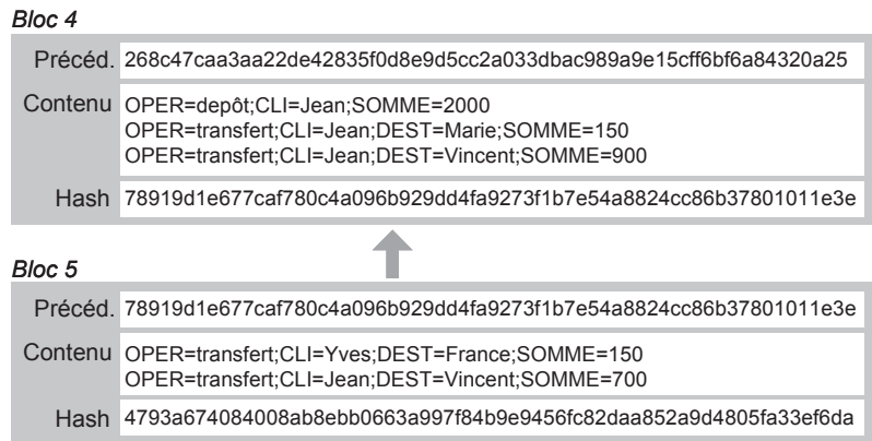
Figure 10.2 - Identification des blocs par hachage cryptographique
