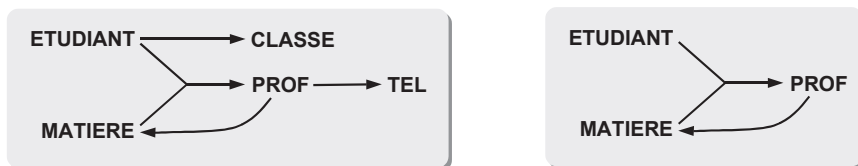
Figure 3.12 - Un graphe ADF comportant un circuit. À droite, le noyau irréductible
