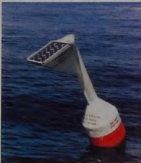
Un exemple de l'intérêt de l'énergie solaire. Cette bouée, munie de panneaux de cellules solaires, fournit en électricité un émetteur radio. Il sert d'aide à la navigation sans qu'il soit besoin d'avoir recours à un combustible.
