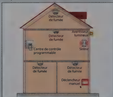
Système d'alarme incendie
